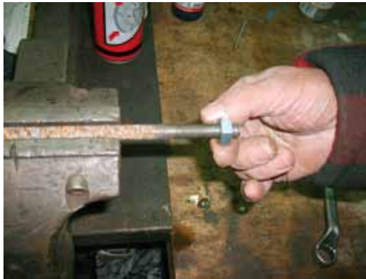
Kurze Zeit später lässt sich die Mutter problemlos mit der Hand aufschrauben.
