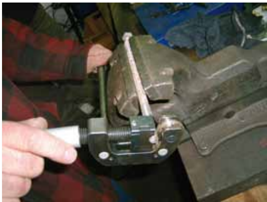
Eine verrostete Gewindestange: mobil gerollt mit dem Gewinderoller der „N-Serie“.
