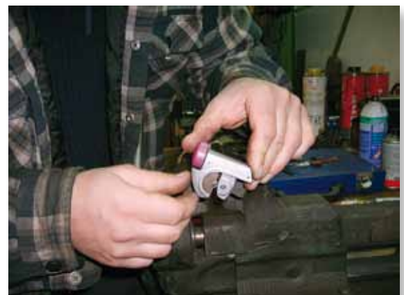
Sekundenschnell und quasi im Handumdrehen ist das beschädigte Gewinde wie neu.
